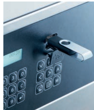
USB-Schnittstelle für schnelle Programm-Updates
